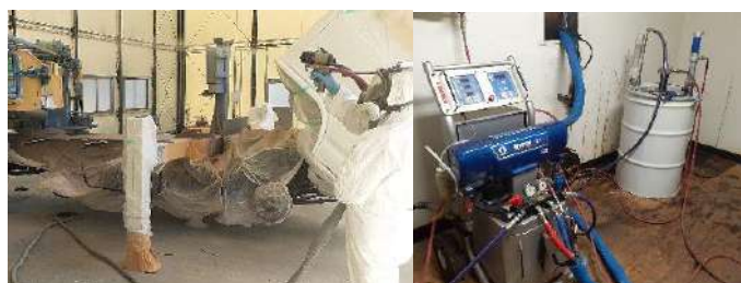
施工用機材 GRACO 製リアクター(画像は E-10hp)
