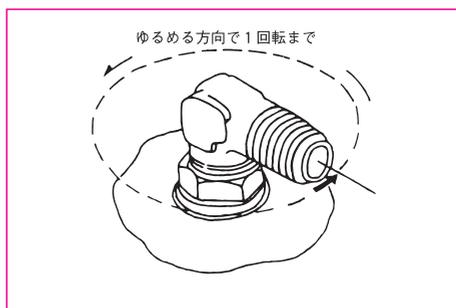
④締付けはチューブ側を組込み後、設定位置がずれないように、スパナなどにより本体を押え、ロックナットを締付けていただきます。
